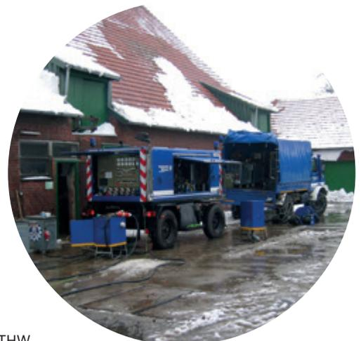
Abbildung 24, 25, 26: Einsatz von Netzersatzanlagen (NEA) zur Notstromversorgung, Quelle: © THW
